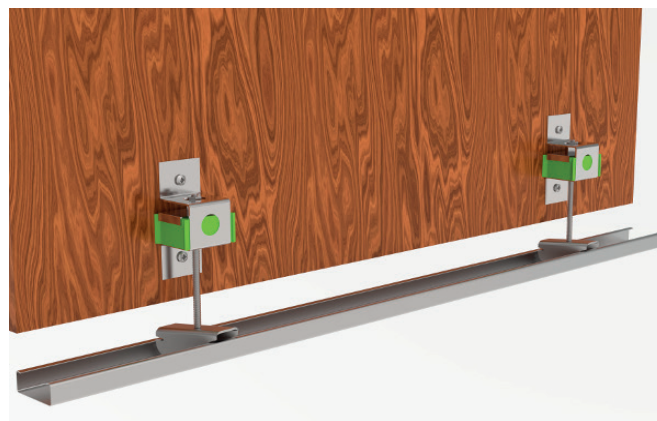
Akustik Lateral + Sylomer®: Il supporto Akustik Lateral è particolarmente adatto nelle strutture dove lo spazio disponibile è ridotto e i supporti acustici devono essere fissati alla trave di legno.
