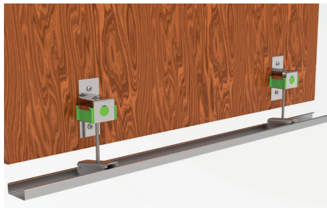
Akustik Lateral+Sylomer®: Der Akustik Lateral Abhängiger wurde für begrenzten Bauraum entworfen. Hierbei kann die Unterdecke seitlich an den Balken fixiert werden, die Abhänge so minimal gewählt werden.
