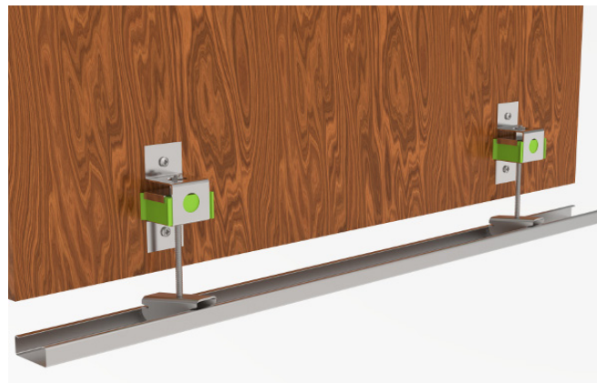
Akustik Lateral+Sylomer®: El soporte akustik Lateral es especialmente adecuado para estructuras donde no hay espacio disponible y los soportes se deben anclar a la viga de madera.
