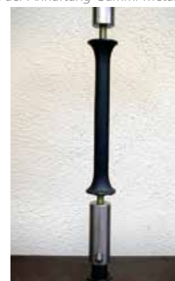
Test der Anhaftung Gummi-Metall
