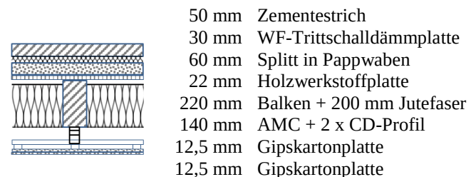
Abbildung 8: Optimierter Deckenaufbau mit Abhängern a)
