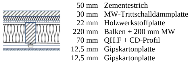
Abbildung 7: Optimierter Deckenaufbau mit Abhängern b)
