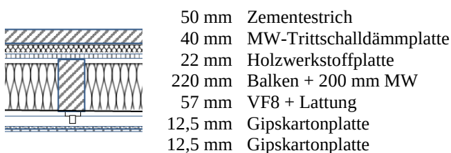
Abbildung 6: Optimierter Deckenaufbau mit Abhängern d)
