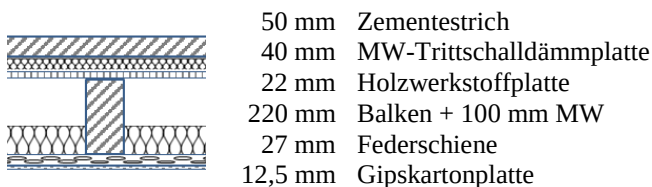
Abbildung 5: Deckenaufbau als Vergleichsdecke
